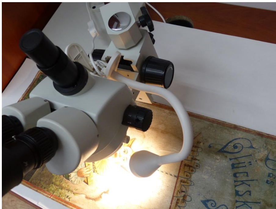
4. kép. A szpotlámpa használata a sztereomikroszkóppal
