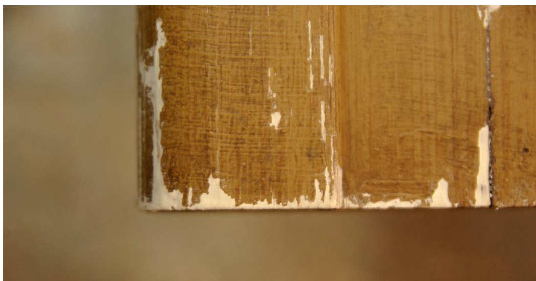
10. kép: A festékhiányok pótlása enyves kréta alappal (a festék vastagságáig feltöltött felület)
