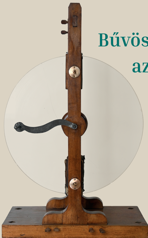
Dörzselektromos gép (XVIII. század második fele)
